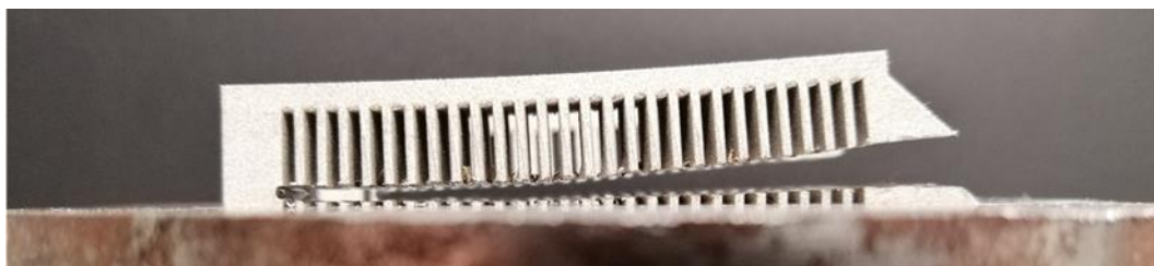
40. ábra, Maradó feszültség mérő próbatest feszültségeinek oldása során kialakuló maradó alakváltozás
