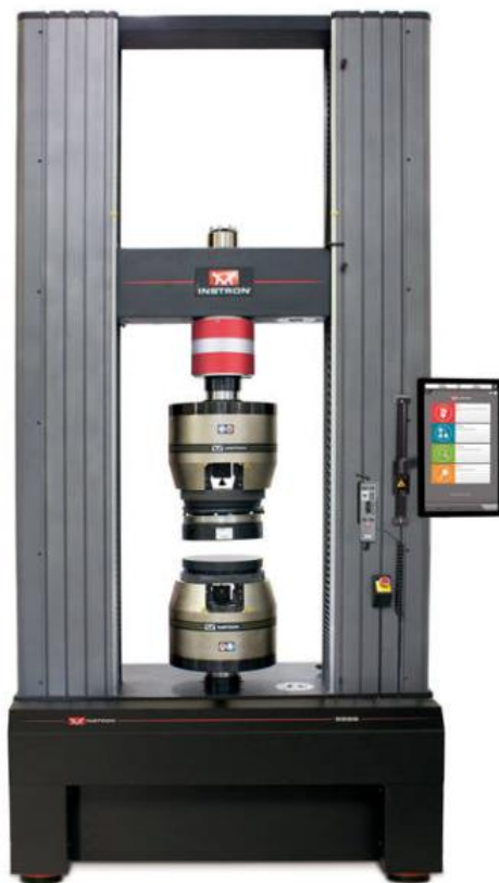
59. ábra, Instron 5980-as szériájú, 600kN erő kifejtésre is alkalmas szakító gép
