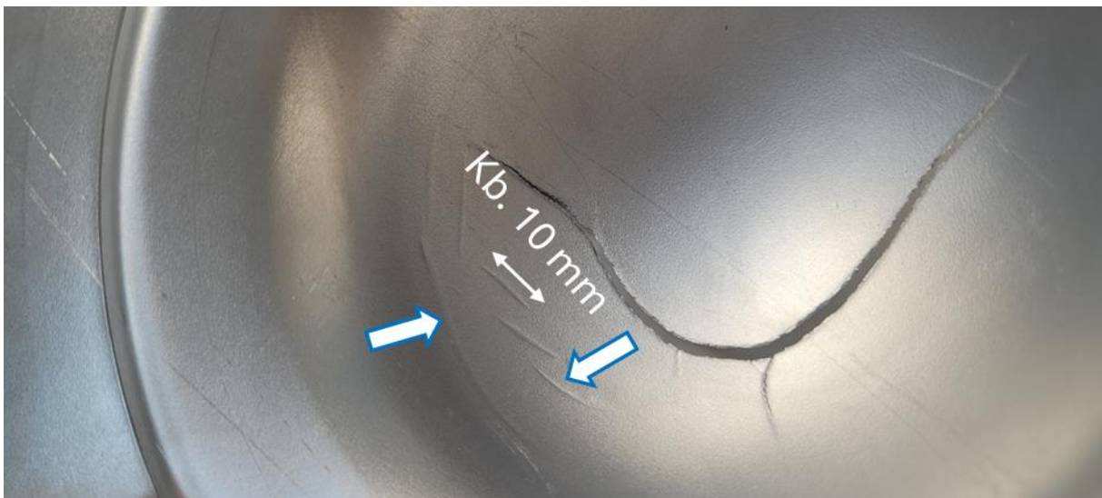
59. ábra. Nakajima próbatesten kirajzolódó lokális elvékonyodás
