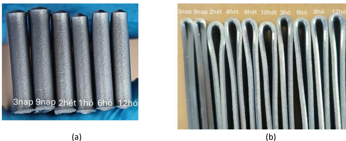
51. ábra Hajlító vizsgálati eredmény a vonatkozó szabvány követelmények szerinti értékelés alapján. Hajlított iv (a) felülnézet (b) oldalnézet (második kör)
