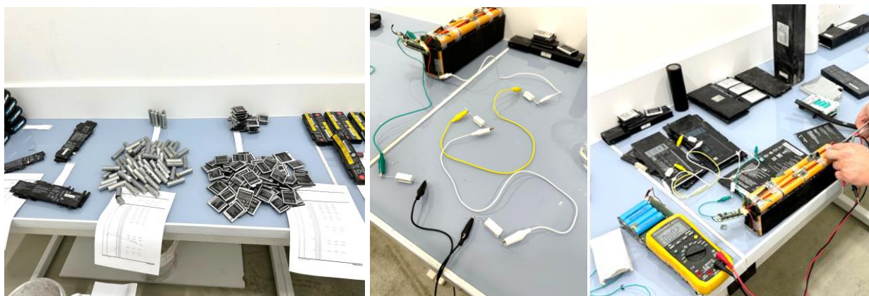
8.ábra A típusonként szétszedett Li-ion akkumulátorok kisütése ohmikus ellenállások alkalmazásával.
