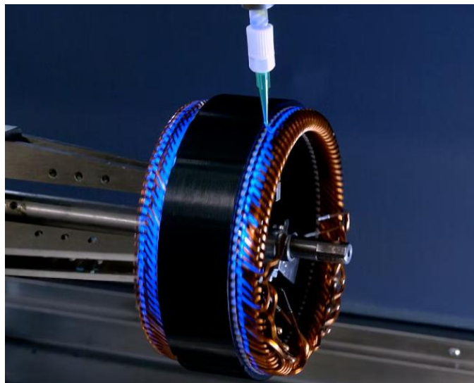
5. ábra Csepegtetési impregnálás folyamata, tekercsfejek impregnálása [24]
