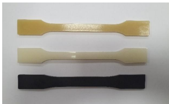
6. ábra Előállított próbatestek alifás poliketon (fehér), 15% üvegszállal (sárga) és 30% üvegszállal (fekete)
